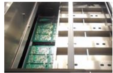
Vakuumeinheit in der Prozesskammer
