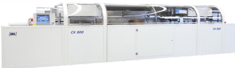
Maschine mit zwei Werkstückträgern kann auch im Batch-Modus betrieben werden und erreicht Zykluszeiten von 20 Sekunden pro Baugruppe.
