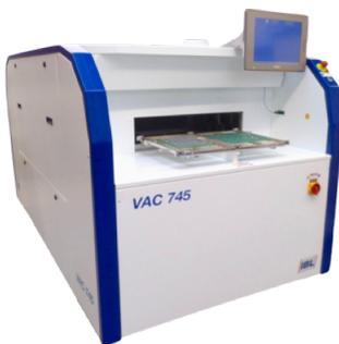
Die Reduzierung von Lunker kann mit Hilfe von Vakuum erreicht werden. Die Vakuumkammer befindet sich im Inneren der Prozesskammer mit einer patentierten Dampfvakuumtechnologie. Auch ohne Vakuumfunktion einsetzbar.
